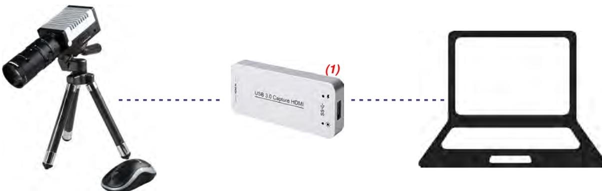
Conecte su sistema de inspección HOROTEC (SMV-B / SMV-2 / SMV-3) con el convertidor de señal HDMI/USB 3.0 (MSA14.151-U) y comparta la cámara de su sistema de inspección en directo mediante las siguientes aplicaciones de videoconferencia :
